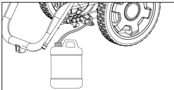
3. Installez la buse de détergent à la connexion rapide (noire) dans la buse de pulvérisation. Le détergent ne sera aspiré à travers la pompe que lorsque la buse de détergent noire est fixée à l'extrémité de la lance.
