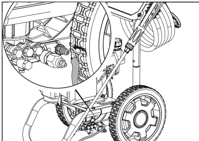
2. Insérez le tuyau d'aspiration de détergent (extrémité avec filtre) dans la bouteille ou le récipient de détergent.
