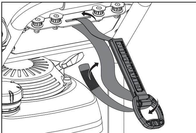
2. Enroulez le tuyau vers le haut soigneusement et enveloppez la courroie autour du Tuyau.
