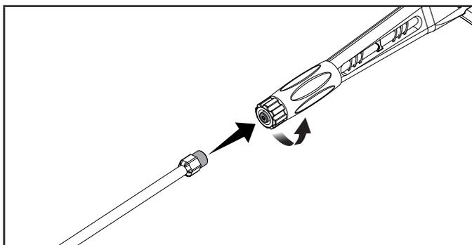
3. Raccordez d'extrémité du tuyau haute pression à l'entrée du pistolet. Serrez la connexion dans le sens horaire. Ne pas trop serrer.
