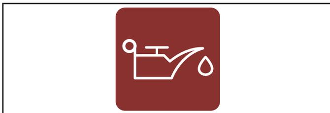
El ícono ROJO se encenderá cuando la presión del aceite del motor caiga por debajo de un nivel de funcionamiento seguro. Cuando se detecte esta falla, el HSB se apagará y el reinicio se desactivará. El ícono ROJO del módulo del controlador y el LED exterior se encenderán.
