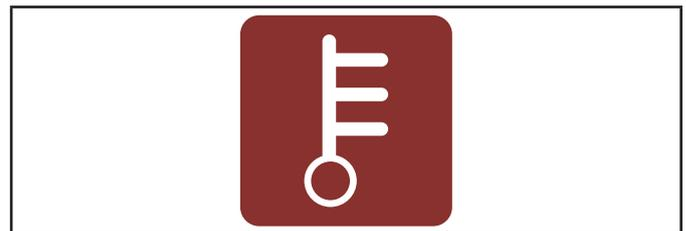
L'icône ROUGE s'allume si la température de fonctionnement du moteur dépasse les limites pré réglées en usine. Si une température de fonctionnement excessive est détectée, la génératrice s'arrête et son redémarrage est désactivé. L'icône ROUGE du aXis Controller® et la DEL du boîtier extérieur s'allument.
