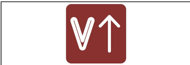
L'icône ROUGE s'allume si la puissance de sortie de la génératrice dépasse les limites prédéfinies de 257 VCA.
