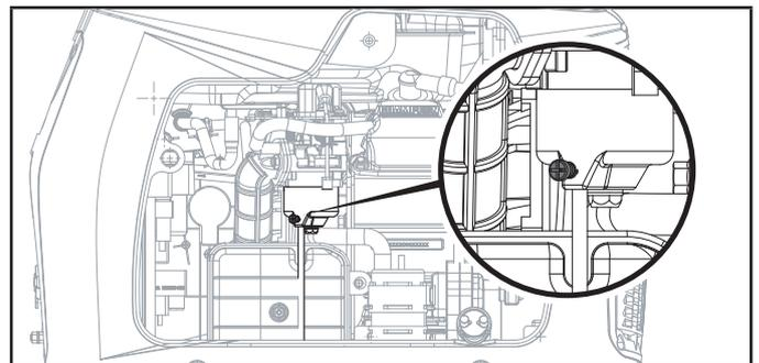
6. Lorsque le carburant ne circule plus dans la tubulure transparente, serrez fermement la vis de vidange en la tournant dans le sens des aiguilles d'une montre. Jetez l'essence vidangée conformément aux règlements et directives locales.
