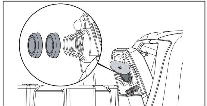
3. Gardez le petit ressort fixé à la colonne en cuivre et réinstallez le ressort comprimé au bas de l'assemblage.
